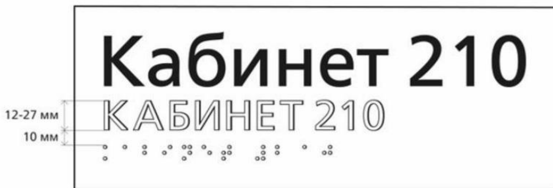
Рисунок 33 — Высота РЛШ при совмещении визуальной и тактильной информации (в данном случае знаки РТШ рекомендуется выполнять прозрачными или в цвет подложки)
