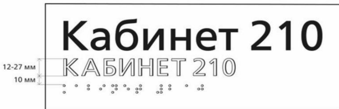
Рисунок 32 — Высота РЛШ при сочетании с плоскопечатным шрифтом (в данном случае знаки РЛШ и РТШ рекомендуется выполнять прозрачными или в цвет подложки)
