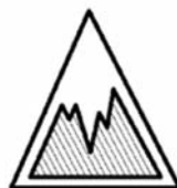
Figura 2. Eticheta pneurilor care îndeplinește valorile minime relevante ale indicelui de aderență pe gheață
